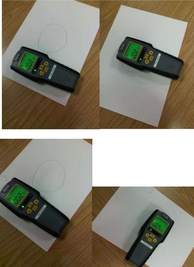
Hier seht ihr vier Fotos die einen Versuch darstellen. Unter dem weißen Papier ist eine zweites Papier gelegt. Bild 1 und 2 alles trocken. 1. Messung 2%, 2. Messung 2%. Bei Bild 3 und vier wurde das untere Papier im Bereich des Kreises ganz leicht angefeuchtet. 1. Messung wieder die 2 % und im Bereich des Kreises 5 %. Also an dieser Stelle ein deutlicher Unterschied und damit Feuchtigkeit im Untergrund festgestellt. Übrigens Metalle im Untergrund können das Ergebnis verfälschen.
