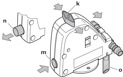
k = commutateur rotatif en position « Fonctionnement »
