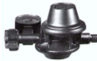
Die Überdrucksicherung ist eine Art zweiter Niederdruckregler und verhindert so, dass im Störfall der Stördruck von z.B. 13 bar am Verbraucher anliegt. Die thermische Absperrvorrichtung hat die Aufgabe bei Temperaturen über (+) 100 Grad Celsius selbsttätig den Gasdurchfluss abzuschalten.
